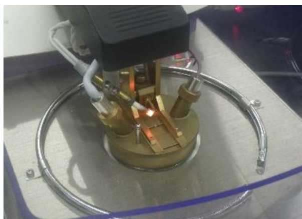
写真4 タグ密閉式引火点試験器
