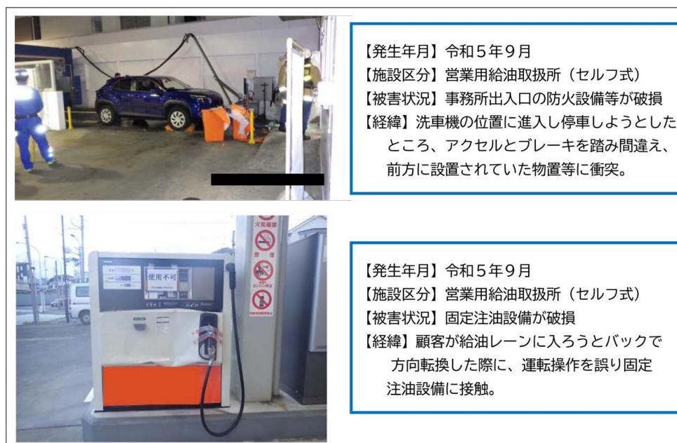
図3 令和5年中に当庁管内で発生した給油取扱所における破損事故の事例
