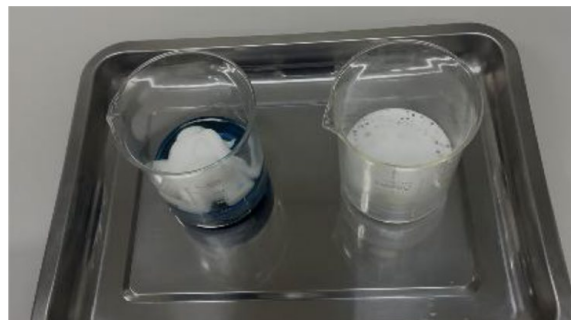
【水溶性及び非水溶性危険物に水又は泡を投入した場合の比較実験】
