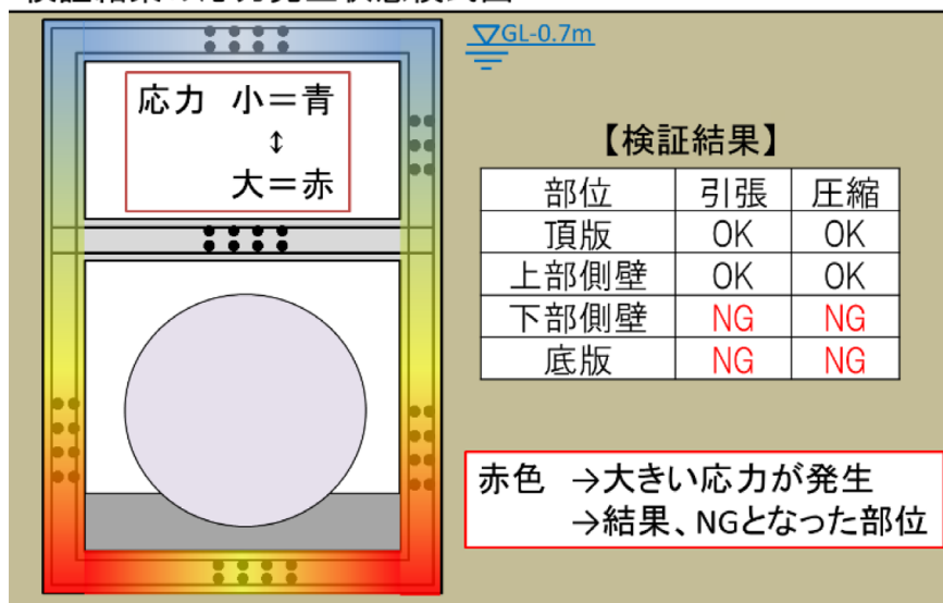
検証結果の応力発生状態模式図
