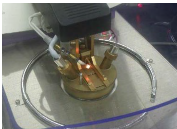
写真4 タグ密閉式引火点試験器
