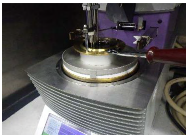
写真5 クリーブランド開放式引火点試験器
