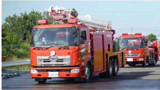
前方：大型化学高所放水車 後方：泡原液搬送車
