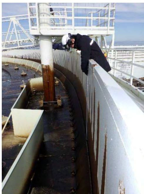
図9 スロッシング波高を実測する様子。タンク側板内壁の油痕を1周見渡して、最も高いものの高さを測定した。
