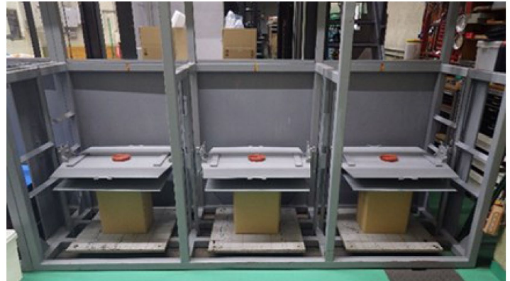
図2 輸送検討会における積み重ね試験の実施状況
