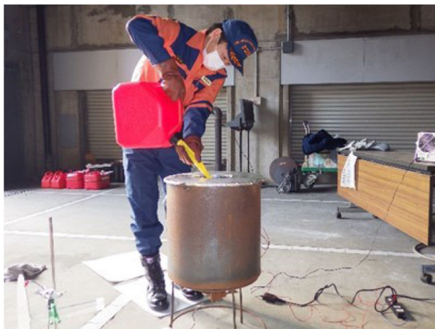
図4 輸送検討会におけるガソリンの電荷量の計測状況
