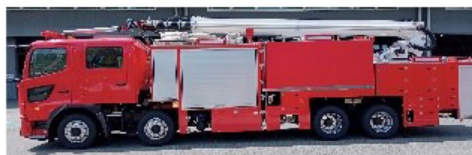
消火薬剤タンク付き大型化学高所放水車
