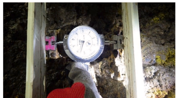
図 18 クラック計による測定
