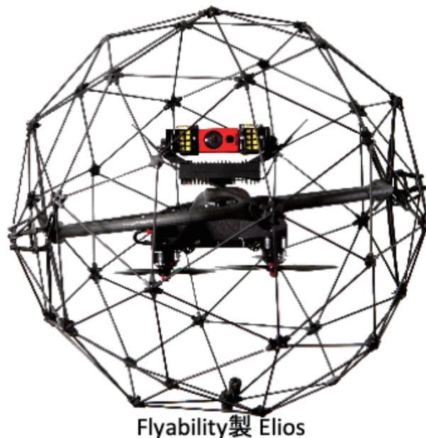
球体のケージで守られているドローンを使用することにより、壁を気にすることなく近接して写真、動画をとることができ、非常に鮮明な画像を取得できる。よってタンクの高所であっても腐食の場所などを正確に把握することができる。
