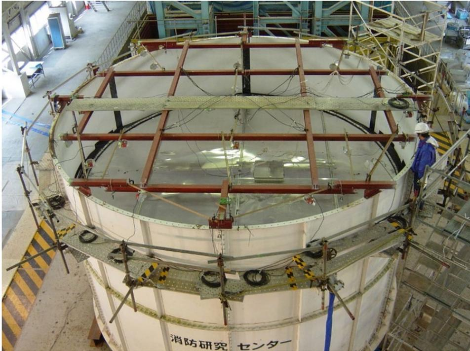
図4 石油タンクの内部浮き蓋の振動実験
