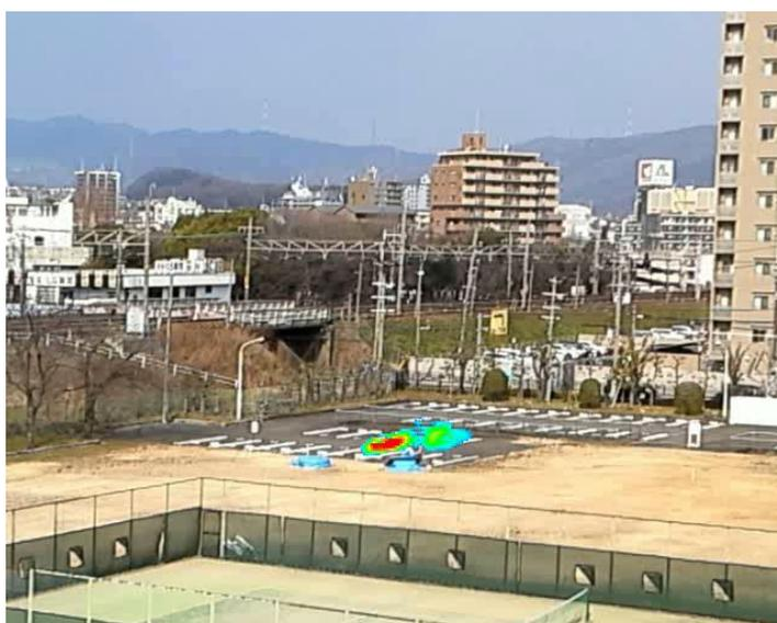
図2-9 可視画像に重畳したガス映像
