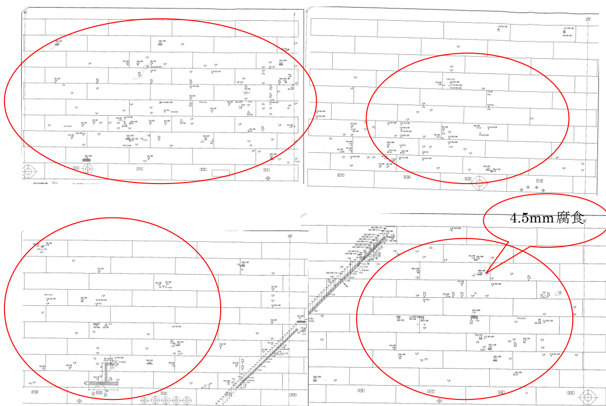
図 4.2-8 保温材取付部の腐食の発生状
