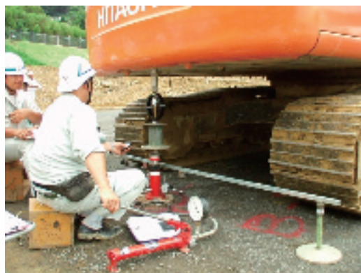
図3 平板載荷試験
