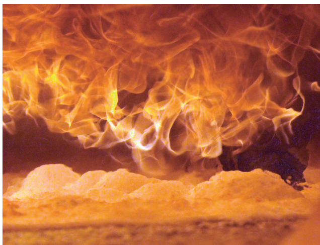
写真2 小規模タンク横方向から撮影した燃焼油面を泡が被覆している様子
