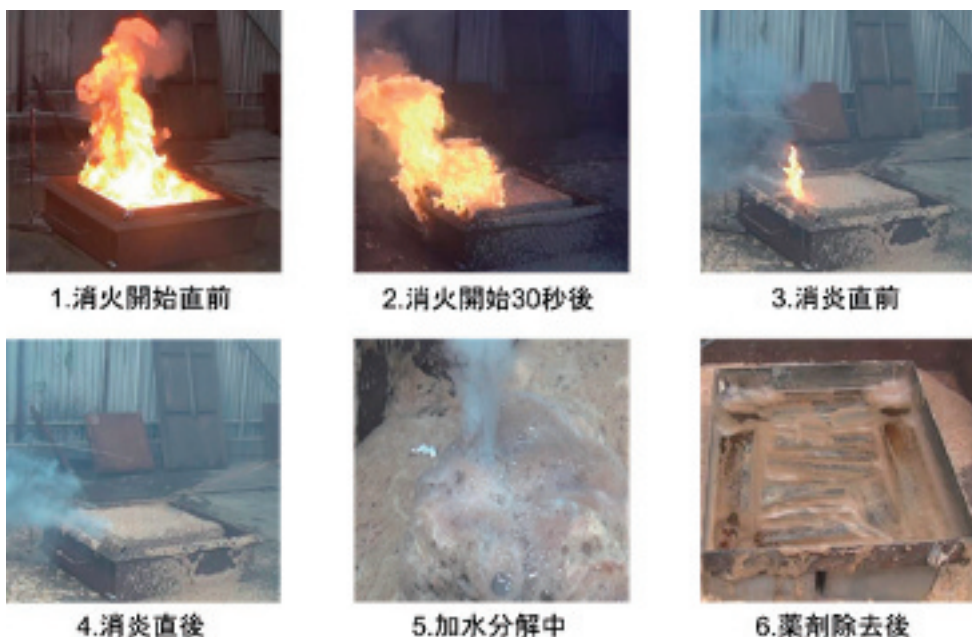
図6．アルキルアルミ類のプール火災消火状況（経時）
