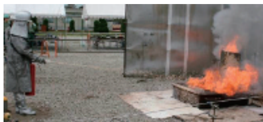
図5. アルキルフォームでの消火試験状況（プール火災模型）
